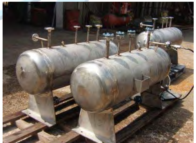
Prova di tenuta idrostatica
